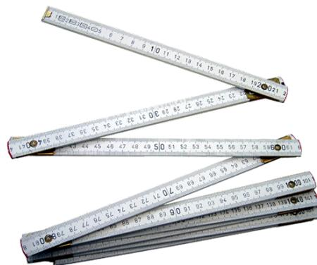
**Abbildung** Gliedermasstab (Zollstock, Meterstab, Doppelmeter)
