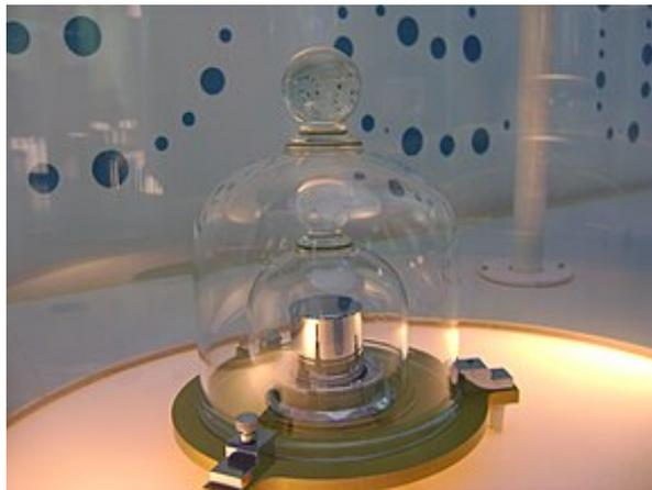
**Abbildung** Replik des Urkilogramms unter zwei Glasglocken.
